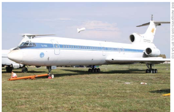
Die Tupolew Tu-155 war das erste Versuchsflugzeug der Welt (1988 bis 1989), das mit Wasserstoff und später mit Flüssiggas betrieben wurde
