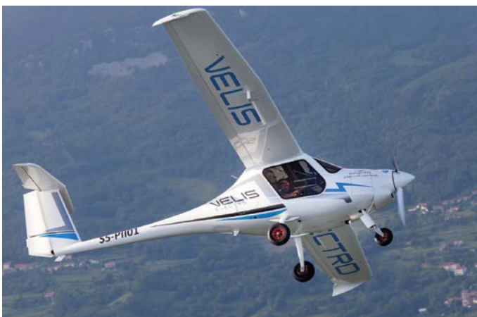
Das Kleinflugzeug Velis Electro von Pipistrel kann mit seiner Batteriekapazität rund eine Stunde lang fliegen
