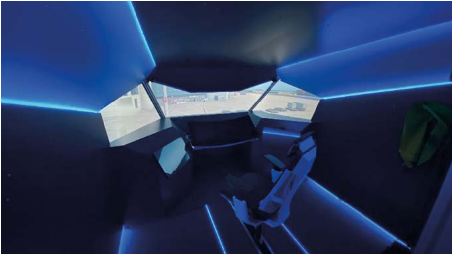
Abbildung 4: Innenansicht des entwickelten Flugsimulators zur Darstellung zukünftiger Flugoperationen
