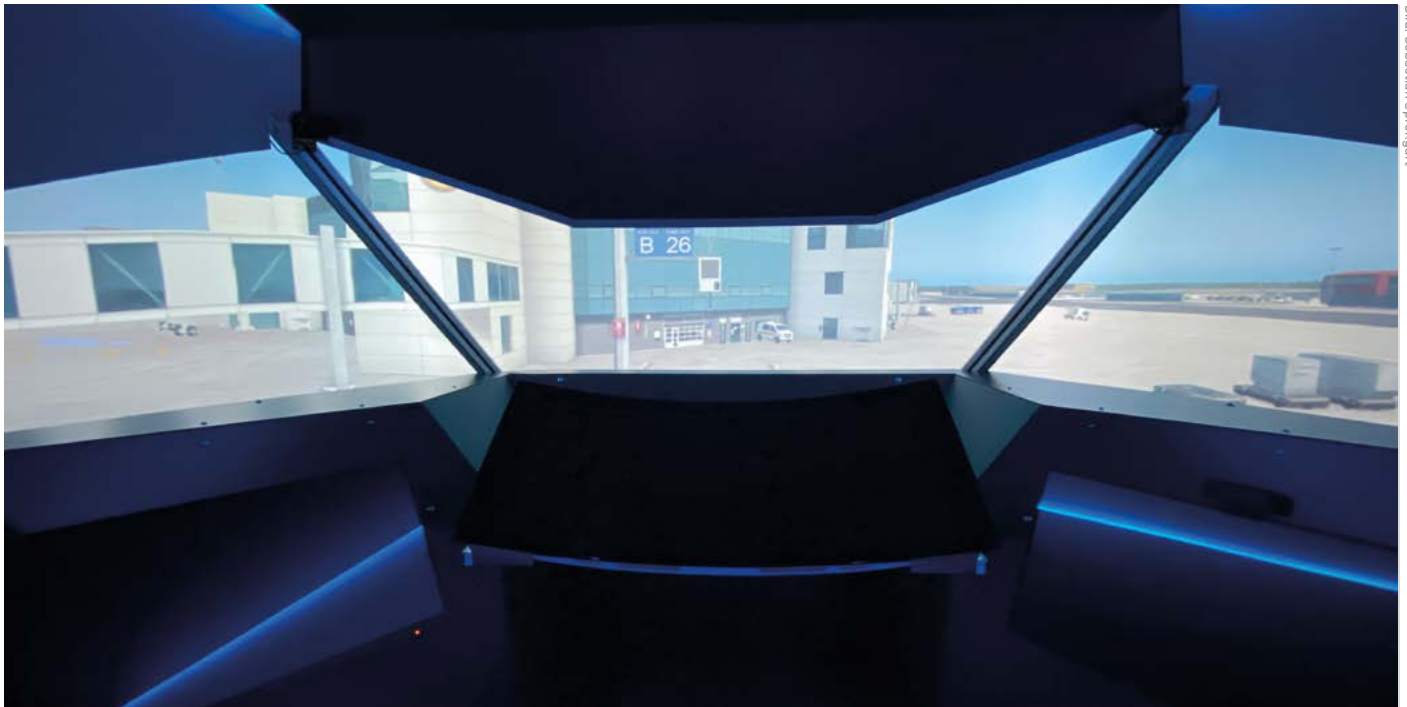
Abbildung 2: Nahaufnahme des Arbeitsplatzes im Simulator mit drei frei konfigurierbaren Touchscreens und Blick auf die simulierte Außensicht
